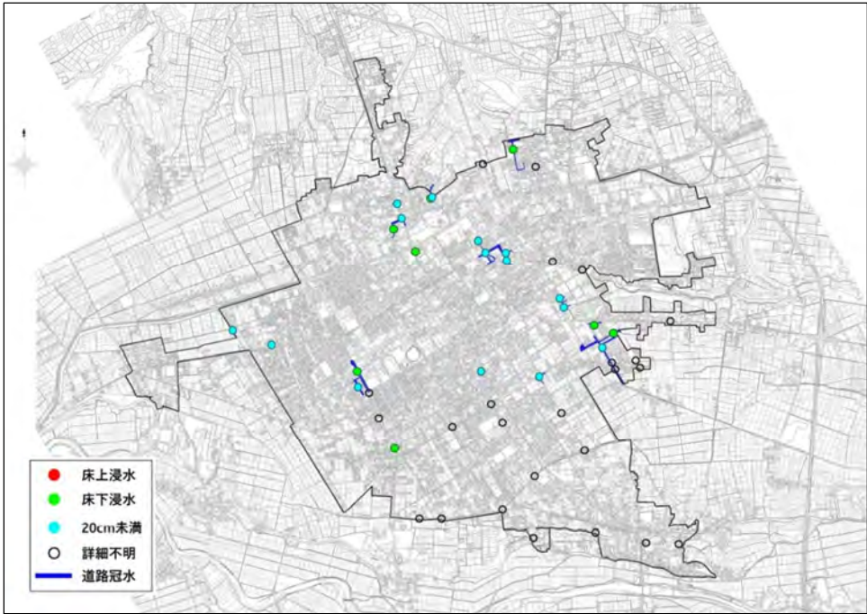
図 2.7 浸水被害発生位置図（H20～R6）（整備後）
