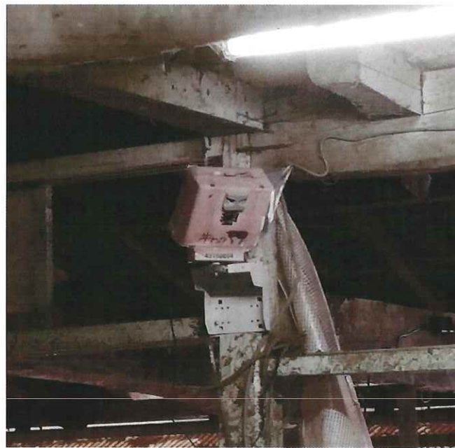
導入されたスマート畜産機材「牛わか」(非接触分娩検知システム)
