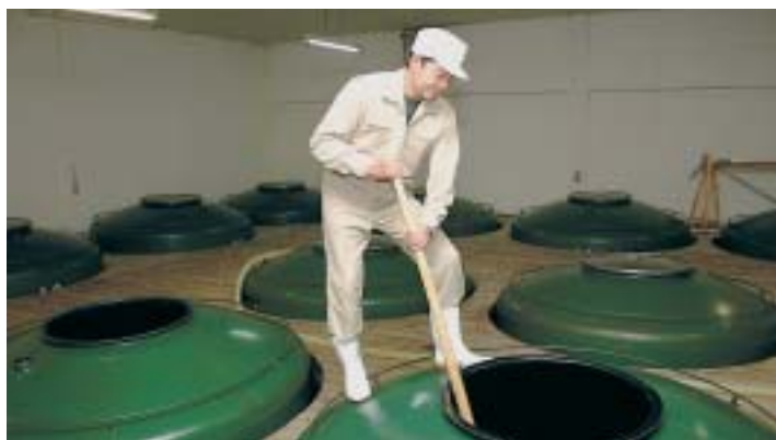
樽でかき混ぜると日々変わるもろみの状態が手に取るように分かります
