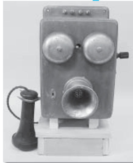
デルビル磁石式壁掛電話器 種別 民俗 時代 昭和30年ごろ 大きさ 高さ 20.5cm 幅 14.6cm 奥行き 12.2cm
