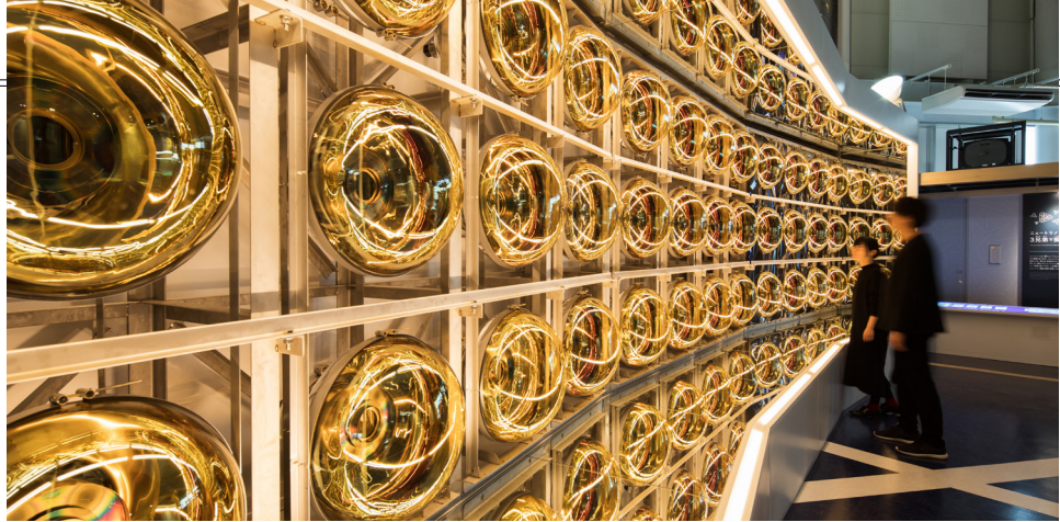
「スーパーカミオカンデ」で実際に使用されている光センサー「光電子増倍管」の取り付け方まで忠実に再現し展示
