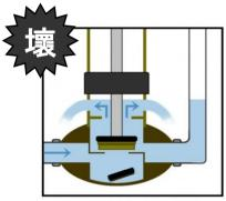
水管墊圈損壞致使水流無法正常停止, 造成水龍頭沒有水流出而有水漏到地 面的現象。
